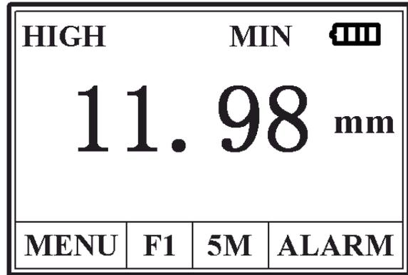
2. 当打开最小测量值捕捉功能时，退出设置后显示屏上有 **MIN** 指示。
