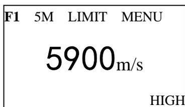
b. 按 **ENTER** 键, 文件号按 F1~F5 可循环显示, 按 **VEL** 键或进行一次测量可退出设置, 文件号设定好之后, 每次测量完可按 **MEM** 键将测量值存入文件, 存储完成后显示一次 “Memory” 进行提示。
