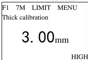
e. 测量厚的标准试块, 用 $\wedge$ 或 $\vee$ 键将测量值调整到标准值, 然后按 **ENTER** 键, 完成校准操作, 即可进行测量状态。
