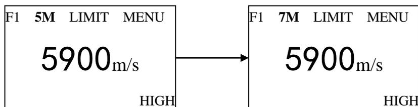
每按一次 **ENTER** 键将依次显示 ZW、5M、7M、2M、ZW，直到设定的所需要的探头频率。
