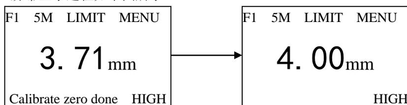
**注意：**每次更换探头后，探头温度、环境温度等工作环境发生变化后，或工作一段时间发现测量值有误差后，都应查看标准试块测量值是否准确，若差别较大就要进行校零操作。
